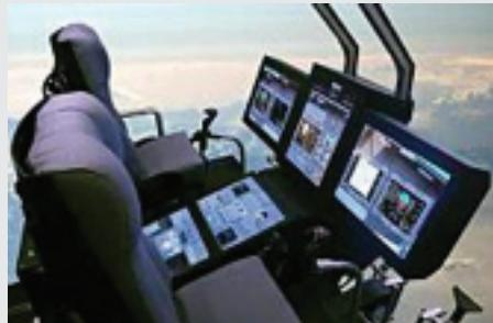
Der CPT ist ein flexibles Ausbildungs-mittel, das sowohl stationär als Nachbau-Cockpit auf der Basis von Touch-Screens mit dazugehöriger Ausbilderstation eingesetzt werden kann, aber auch mobil auf Laptops oder PCs.
